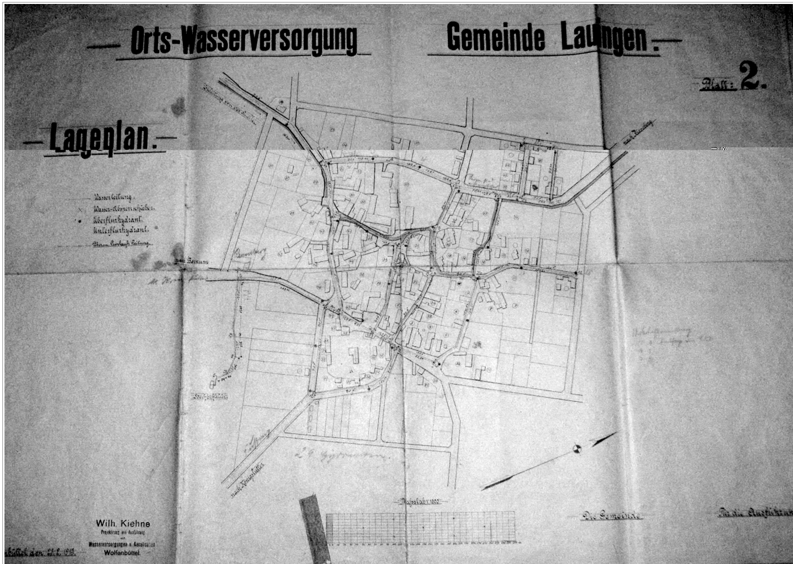
Ortswasserversorgung Lauingen von 1913 (vorerst ohne Ringleitung)
